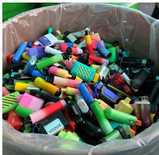
E-Zigaretten korrekt verpackt im Batteriefass, Foto: IKL
