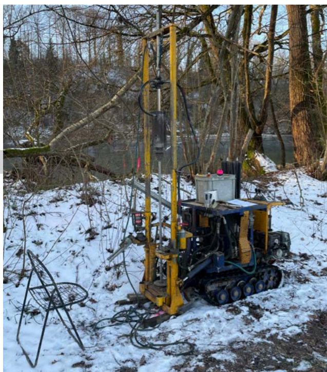
Natur und Technik: Rammsondierung am Rheinufer bei Hemishofen. Foto: IKL
